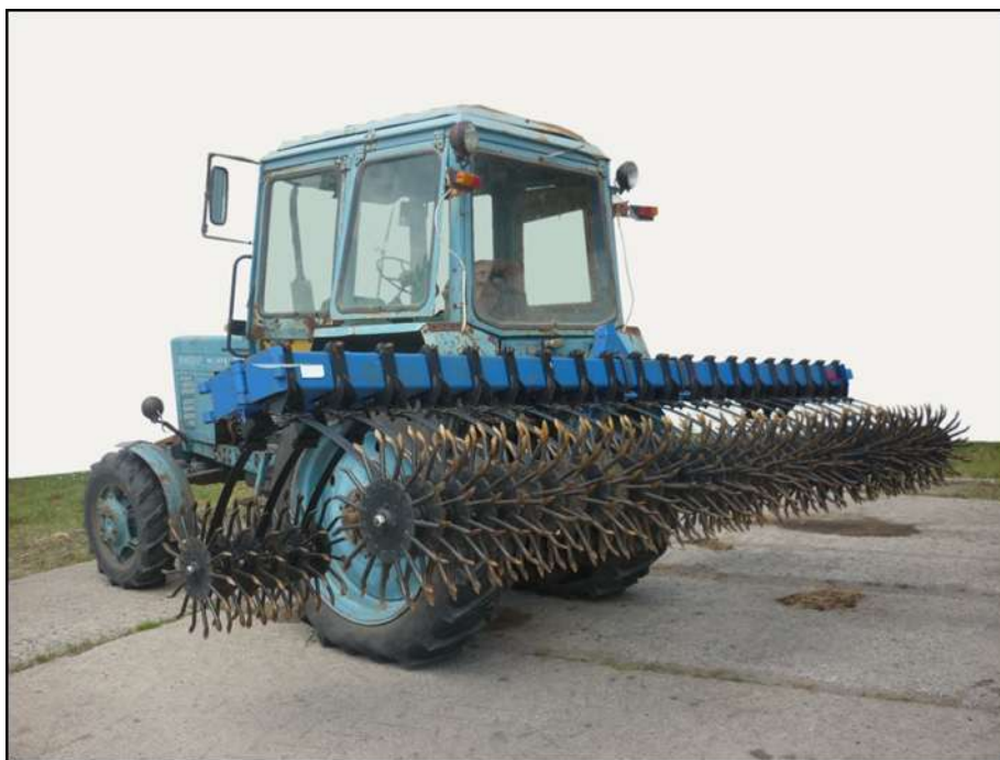
Рисунок П.3 – Борона мотыга ротационная БМР-5,6 в транспортном положении. Боковые секции рабочих органов, по три с каждой стороны, развернуты вперед по ходу агрегата
